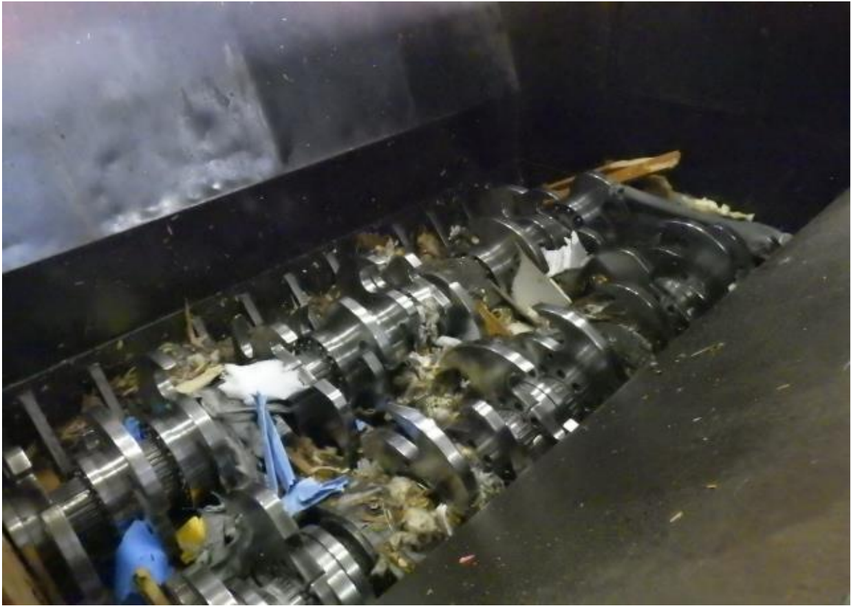
二軸せん断破碎機（2本の軸で回転する刃により粗大ごみなどを細かく裁断する機械）
