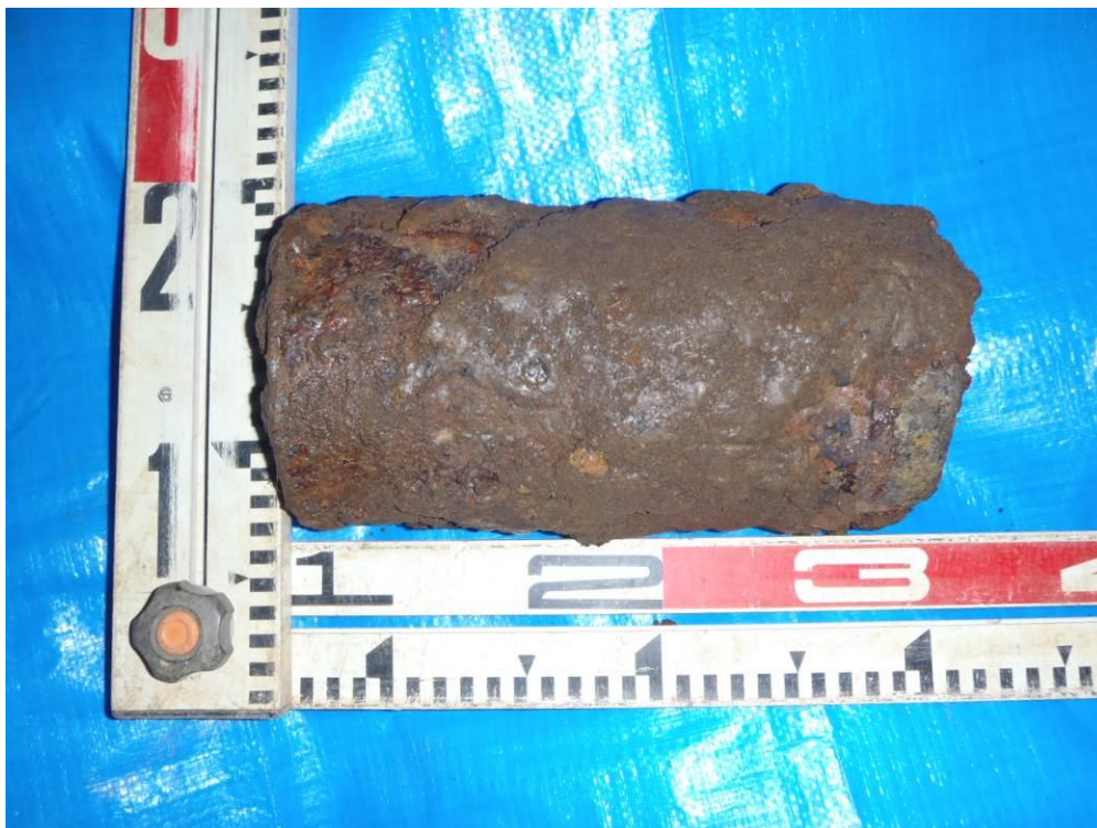
写真2 発見された老朽化したあか筒の可能性がある物体 (写真1とは別のもの) (写真撮影：環境省)
