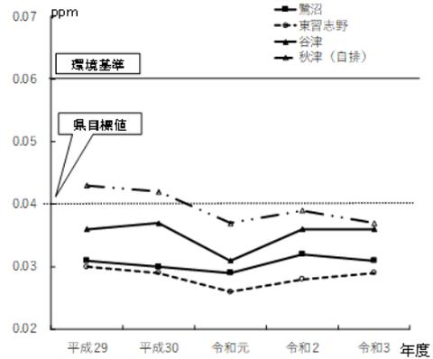
図 4.6.3 二酸化窒素(NO<sub>2</sub>)経年変化
