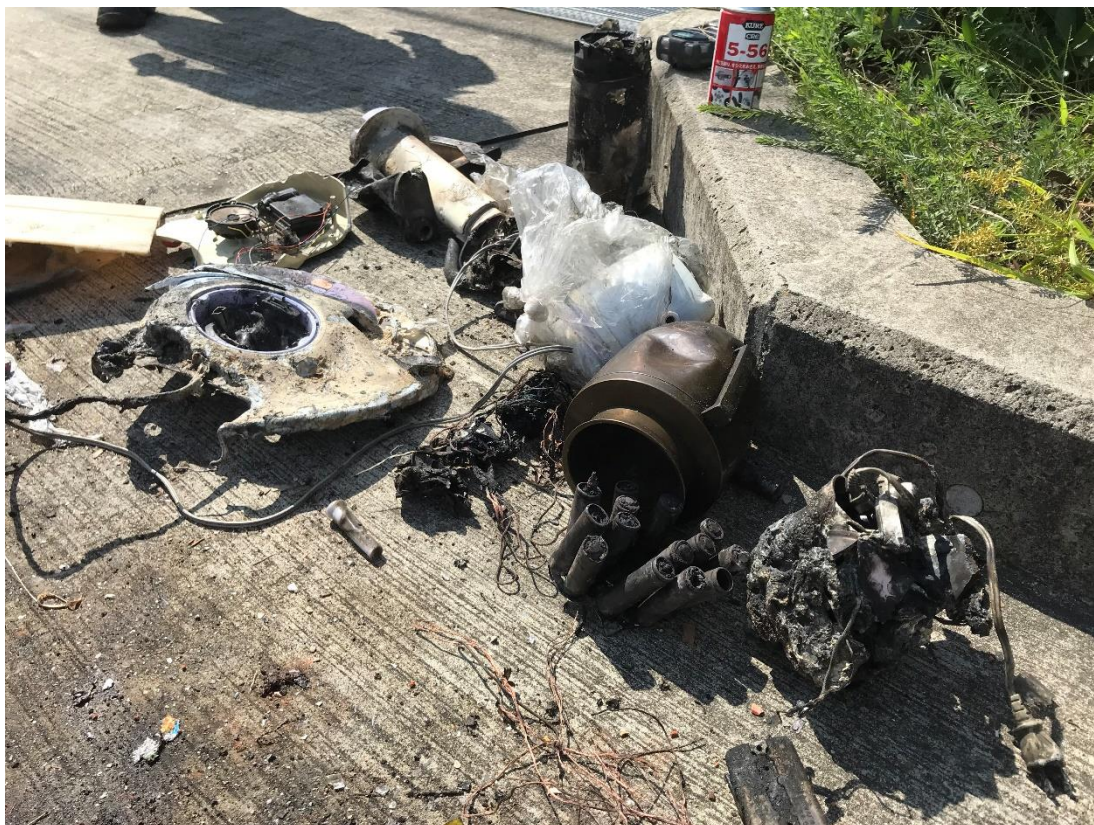
有害ごみ(充電式電池)の混入により発火した事例（令和3(2021)年10月6日）
