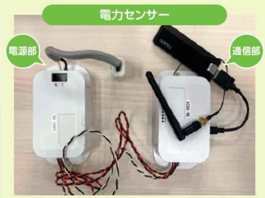
<電源部・通信部の寸法> 幅:130mm/高さ:35mm/奥行き:70mm
