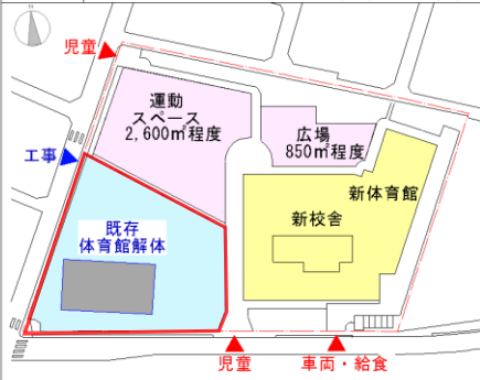
Step⑥ 既存体育館解体(2期工事) [4ヵ月] R11年11月～R12年2月
