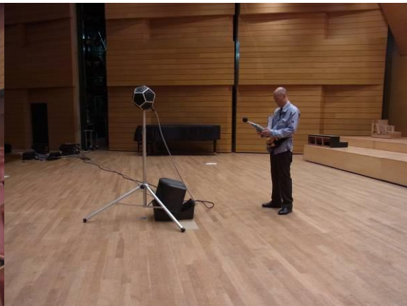
空調騒音の測定
