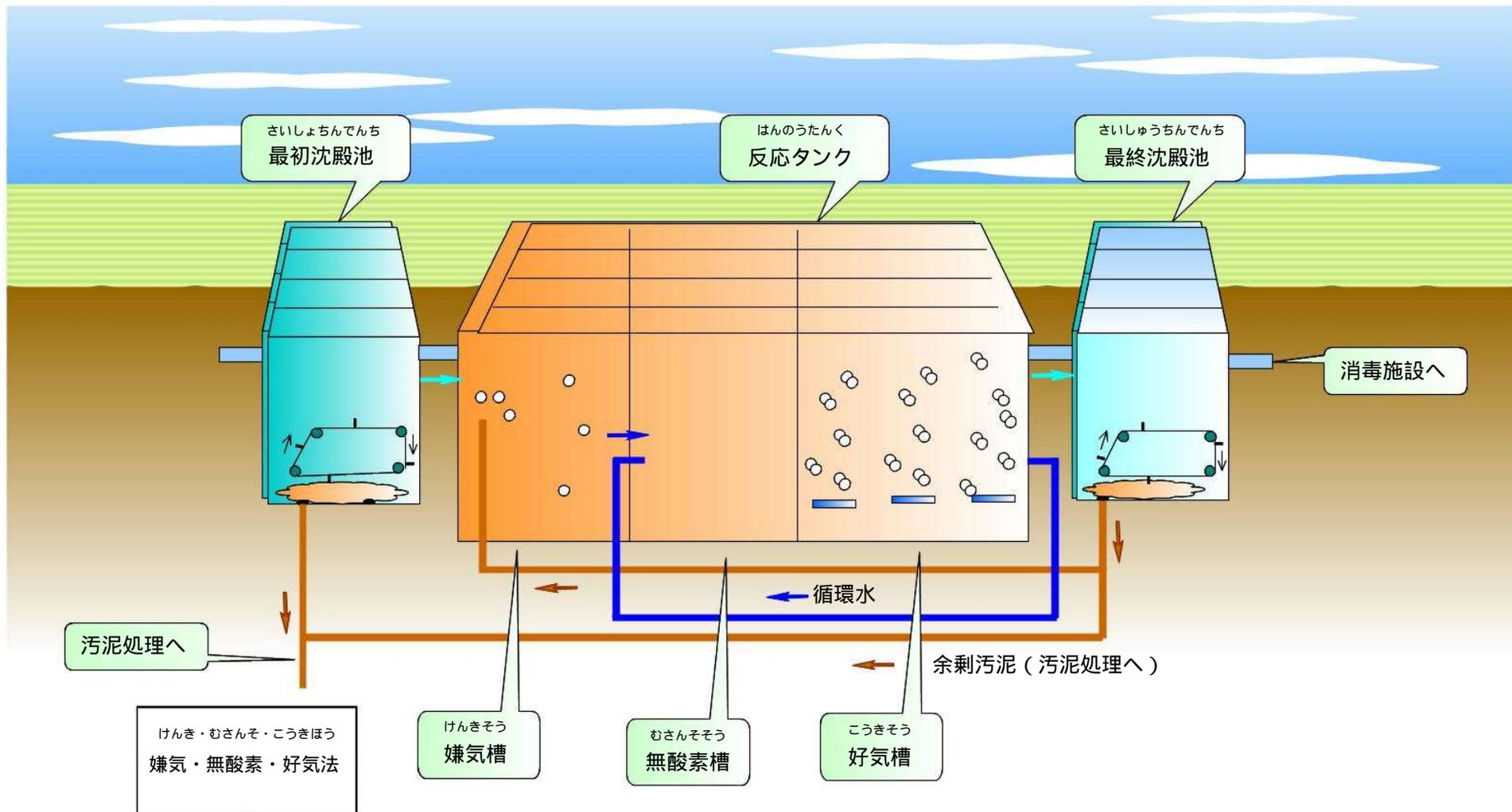
嫌気・無酸素・好気法は標準活性汚泥法と同様に微生物を利用した水処理方法ですが、標準活性汚泥法では処理きれない窒素やリンの除去が可能な処理方法です。微生物の働きにより、窒素は好気槽から無酸素槽へ循環させることで窒素除去が可能になり、また、リンは嫌気・無酸素槽を通過して、好気槽へ進むことでリンの除去が可能となります。嫌気・無酸素・好気法はこの窒素とリンの処理のしくみを合わせた処理方法となっています。
