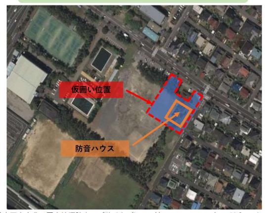
防音ハウスイメージ図(縦34m×横34m×高さ14m)
