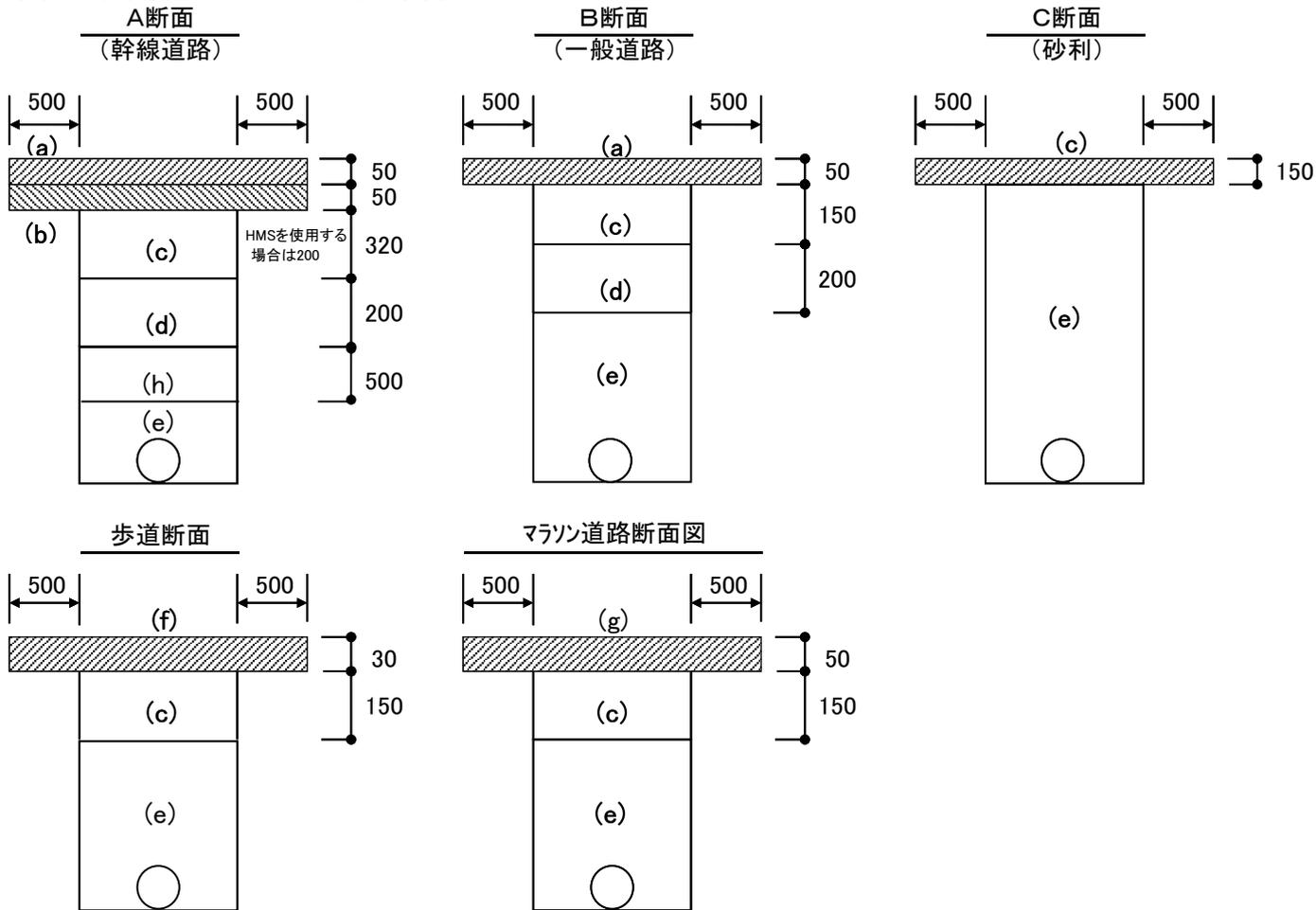
習志野市道標準復旧断面図(埋立地)
