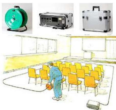
図 情報伝達・意思疎通支援の推進 (磁気ループ設置イメージ)
