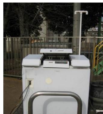
天然ガス充填機
