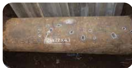
埋設後40年経過した水道管の様子 腐食により生じたくぼみが確認できます
