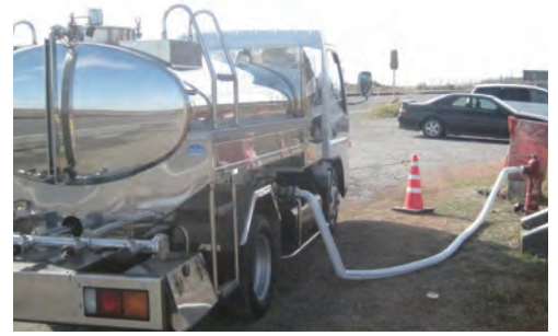
消火栓から給水車に水を補充
