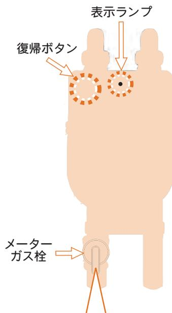
ランプが点滅したままガスを使用すると、再びマイコンメーターが遮断してしまうので、必ず点滅が消えたのを確認してから、ガスを使用してください。
