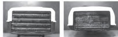
○目詰まりしていない熱交換器    ×目詰まりしている熱交換器
