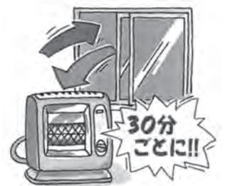
小型湯沸器をご使用の際は、必ず換気扇を回すか窓を開けましょう。(湯沸器を使うと自動的に換気扇が回る、連動換気扇スイッチを取り付けると便利です。)
