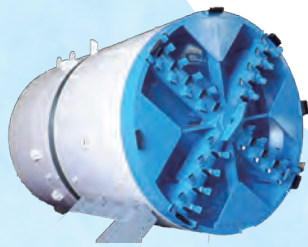
第3工区シールドマシン
