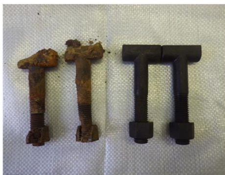
【習志野市】水道管を接合するボルト・ナット (左)40年経過 (右)新品
