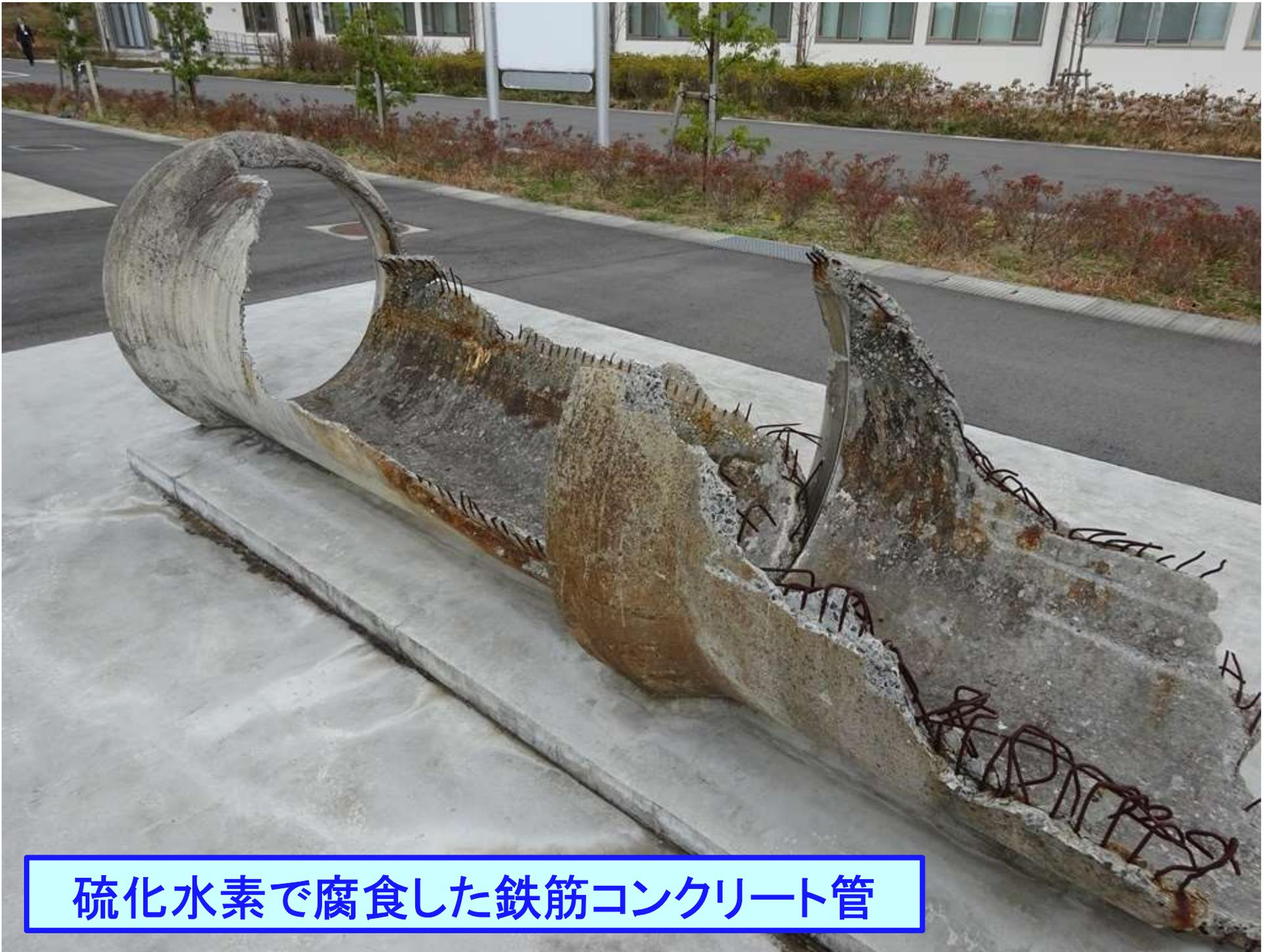
硫化水素で腐食した鉄筋コンクリート管
