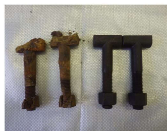
水道管を接合するボルト・ナット (左) 40年経過 (右) 新品
