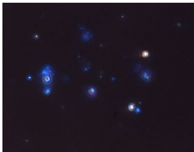
浸液屈折率1.680:アモサイト 確認されず
