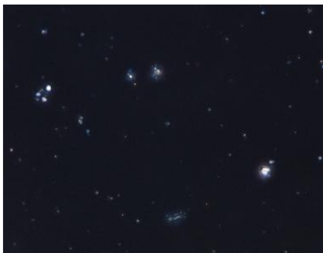
浸液屈折率1.550:クリソタイル 確認されず
