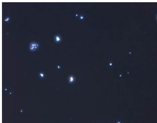
浸液屈折率1.680:アモサイト 確認されず
