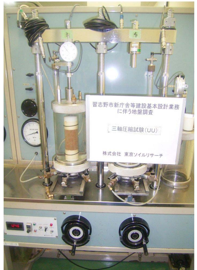
三軸圧縮試験 (UU)
