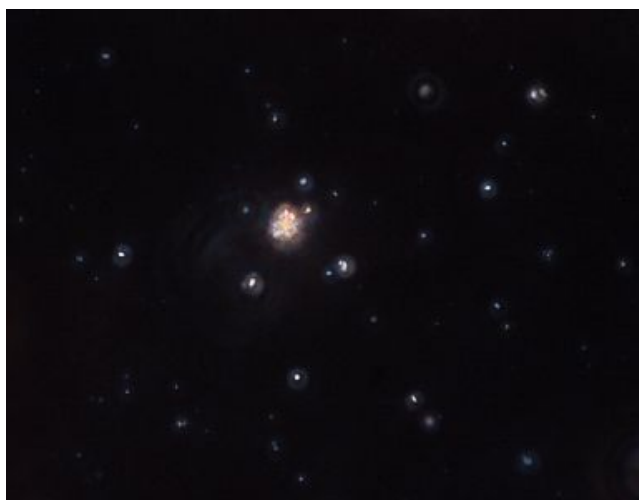
浸液屈折率1.626:アクチノライト 確認されず
