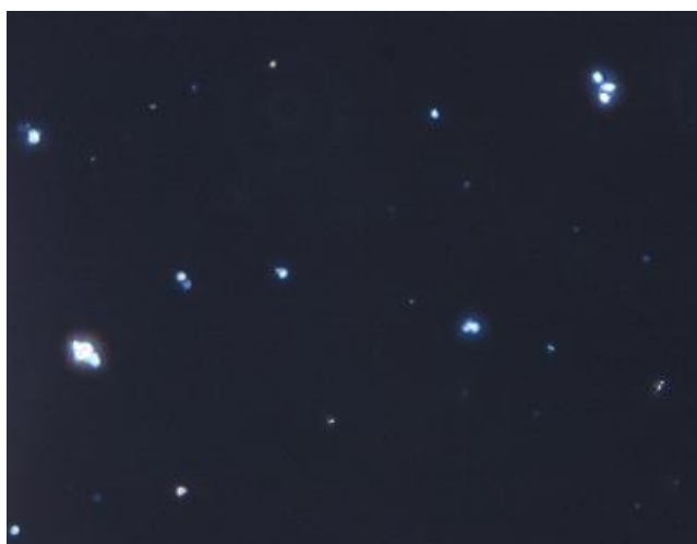
浸液屈折率1.690:クロシドライト 確認されず
