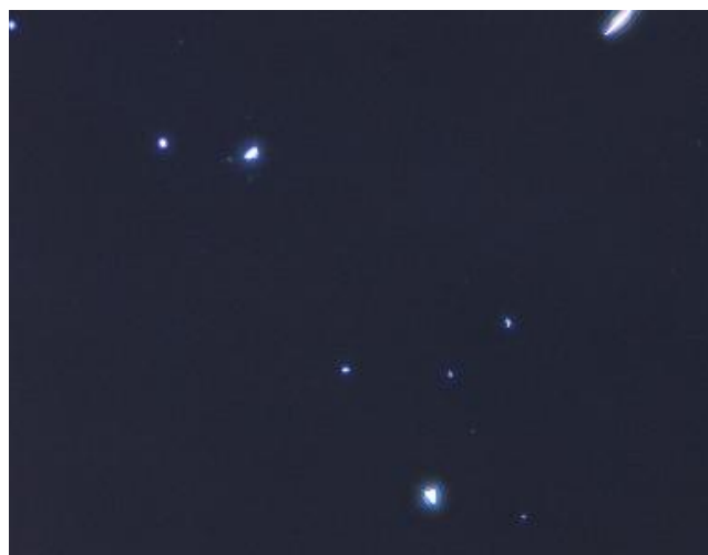
浸液屈折率1.680:アモサイト 確認されず
