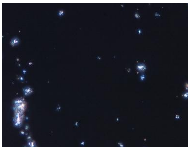
浸液屈折率1.620:トレモライト 確認されず
