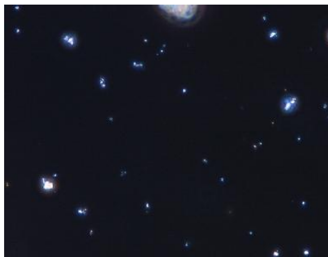
浸液屈折率1.680:アモサイト 確認されず
