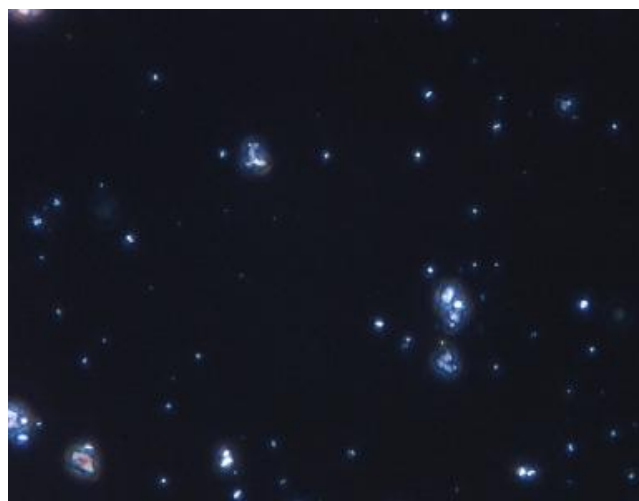
浸液屈折率1.680:アモサイト 確認されず
