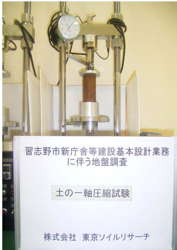
土の一軸圧縮試験
