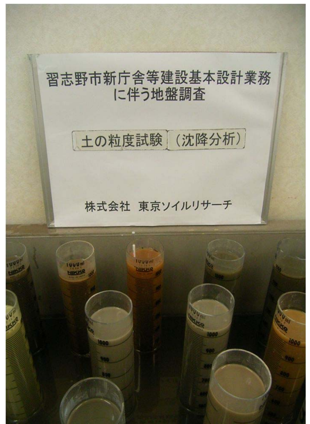
土の粒度試験 (沈降分析)
