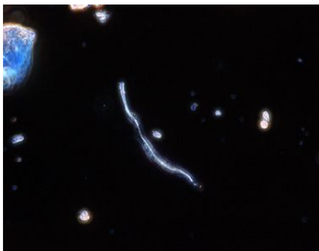
浸液屈折率1.680:アモサイト 確認されず
