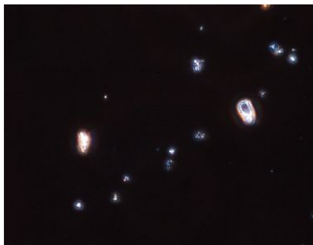
浸液屈折率1.618:アンソフィライト 確認されず
