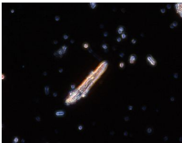
浸液屈折率1.680:アモサイト 確認されず
