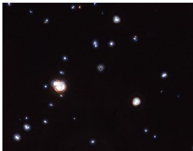
浸液屈折率1.680:アモサイト 確認されず
