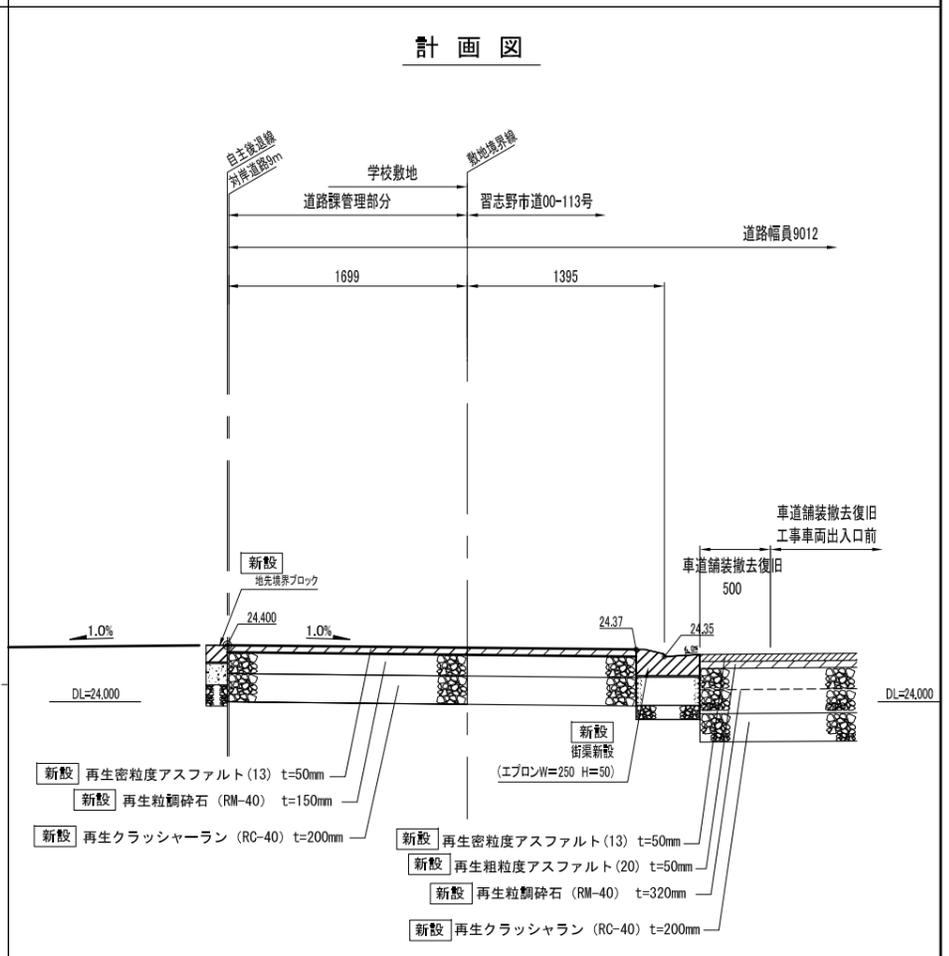
1 既存車道舗装撤去復旧・車道、乗入舗装新設 A1版S=1:20、A3版S=1:40
