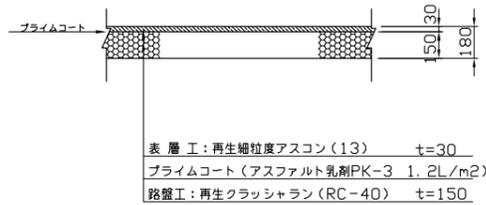
3 歩道舗装新設(透水性アスファルト舗装) A1版S=1:20、A3版S=1:40
